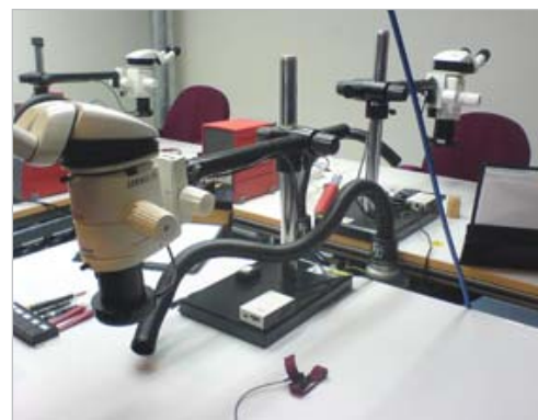
Lödning och limning under mikroskop
